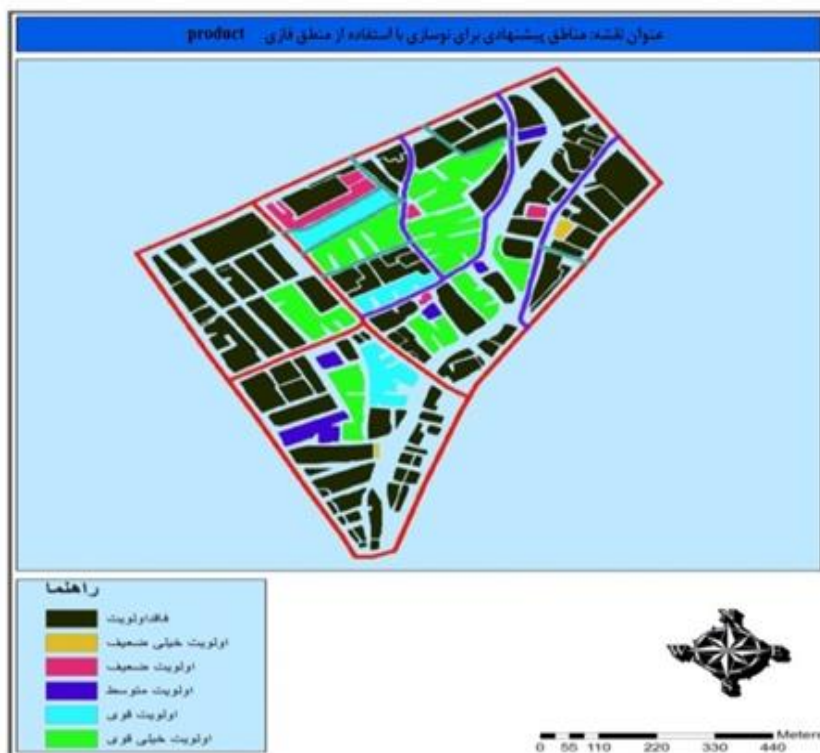
شکل ۵: نقشه نهایی مناطق اولویت‌دار برای امر نوسازی بافت فرسوده با استفاده از عملگر Product فازی
