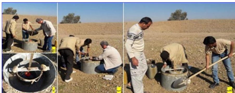
شکل ۲: نمونه استوانه مضاعف اندازه گیری نفوذپذیری
