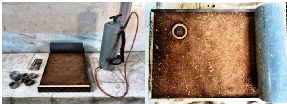
شکل ۱: شبیه‌سازی فلوم برای رسیدن به تعداد بهینه رفت‌و برگشت غلطک
