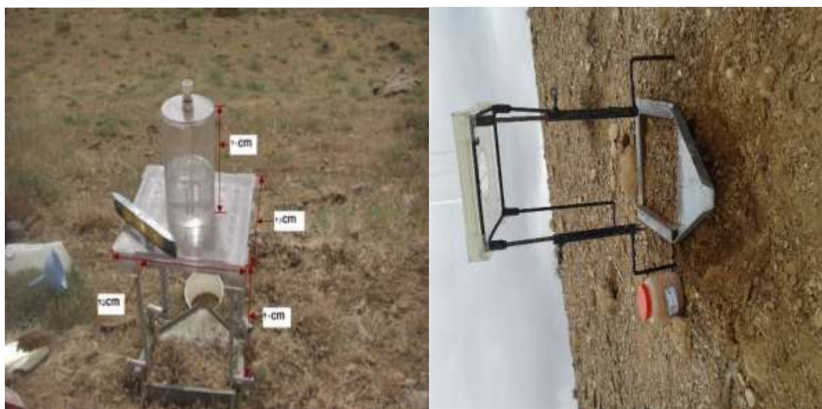
شکل ۳: دستگاه شبیه‌ساز باران در محل اجرای آزمایش با فرسایش خندقی در مارن M1
