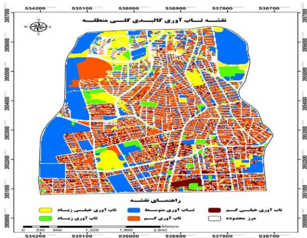
شکل ۴: نقشه تاب‌آوری کلی منطقه ۶ در برابر زلزله
