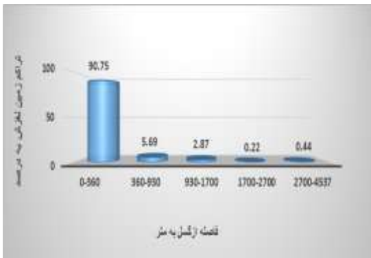
شکل ۱۵: نمودار درصد تراکم ناپایداری دامنه‌ای در کلاس‌های فاصله از گسل Figure 15: Density percent plot of slope instability for distance to fault classes
